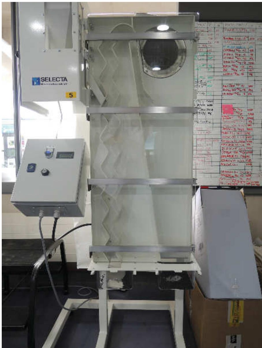
Mithilfe des Zig-Zag Aspirator, werden 95% des Saatgutes in der MSB gereinigt. Die Absauganlage entfernt leichteres Material wie Spreu und leeres Saatgut aus der Sammlung. Das intakte Samenkorn fällt nach unten in eine Schale. Nur zu große oder zu feine Samen, wie die der Orchideen, können nicht in der Anlage gereinigt werden.
